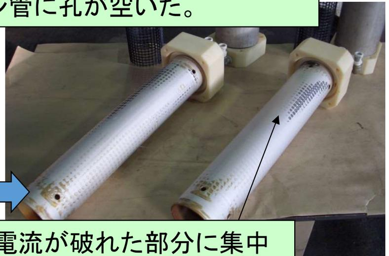
中性膜が破れたため、電流が破れた部分に集中して白金メッキが剥がれた。(5400時間使用後)
